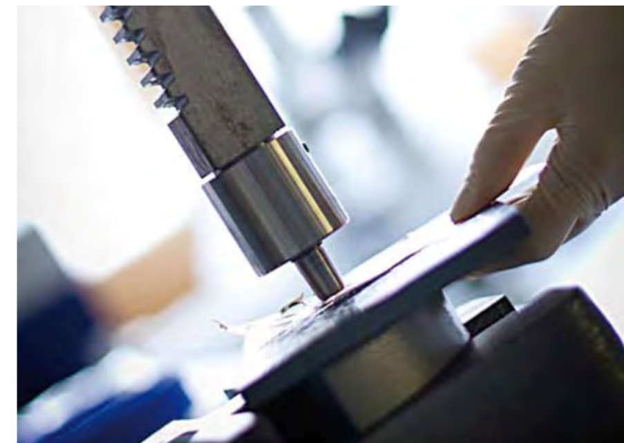
Ausgestanzte: Prüfkörper für In-vitro-Testungen bei BioMedimplant.
