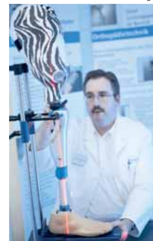
Statischer Aufbau einer Beinprothese mit Laser-Assembly (Laserlot)
