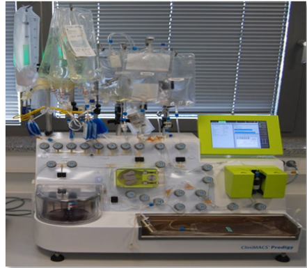
Abb. 4: A. Proliferierende CAR-T-Zellen im CliniMACS Prodigy (Vergrößerung 400fach) vier Tage nach Start der Kultivierung (Zuther et al., 2017, J Onkologie, im Druck). B. CliniMACS Prodigy System zur Herstellung GMP-konformer Zellprodukte.
