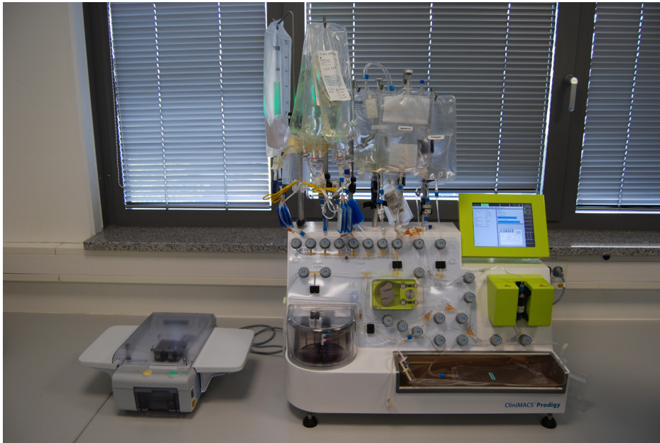
Abb. 1: Vollautomatische Aufreinigung antigen-spezifischer T-Zellen. Im Clinical-Scale-Up-Raum der GMPDU, Institut für Zelltherapeutika, wurden Testläufe mit dem neuen vollautomatischen CliniMACS Prodigy (Miltenyi Biotech) zur Herstellung antigen-spezifischer T-Zellen und anderer Zellprodukte durchgeführt. Im Vergleich zu etablierten Geräten, mit denen eine manuelle Aufreinigung und Zellexpansion verschiedener Zellprodukte unter GMP-Bedingungen erfolgt, erlaubt das neue Gerät eine zeitsparende und standardisierte Herstellung antigen-spezifischer T-Zellen.
