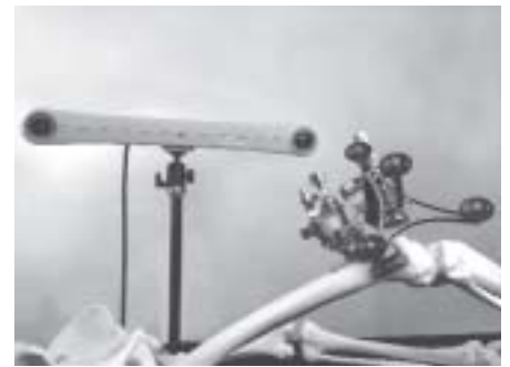
Ein neues Navigationssystem mit zwei Videokameras hilft bei der Überwachung und Steuerung von Operationen (AXIOS 3D).
